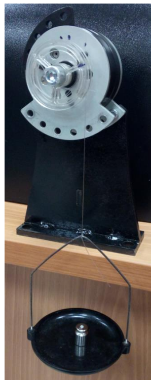
Рис. 8. Установка для проведения измерений момента трогания редуктора с передаточным отношением, равным 100
