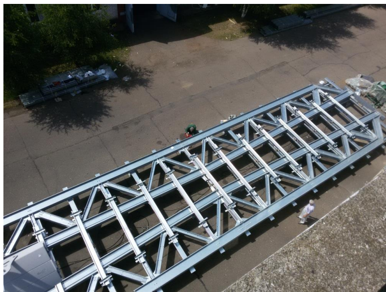
Рис. 2. Общий вид испытательного стенда с установленными стропильными фермами
