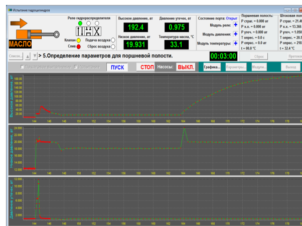
Рис. 3. Компьютерный блок установки для испытания гидропривода (показано состояние гидроцилиндра)
