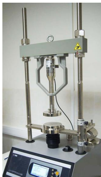
Установка UNIFRAME для испытания образцов дорожно-строительных материалов
