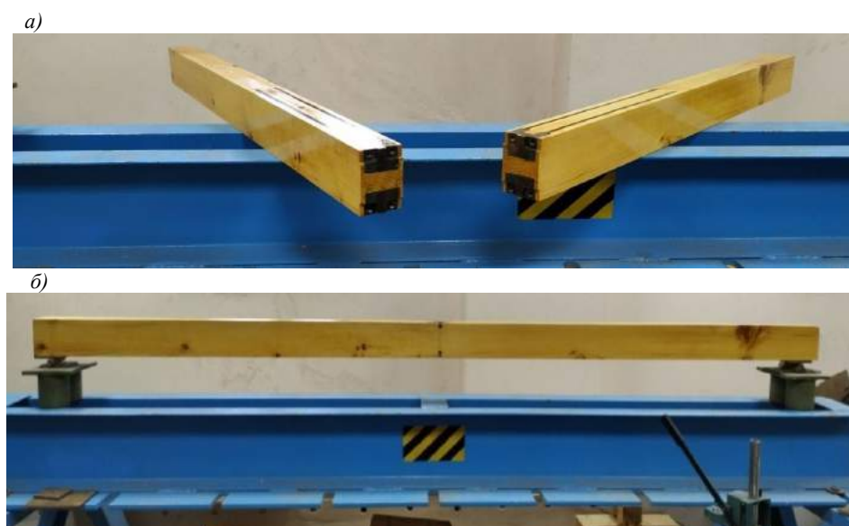
Рисунок 3. Узловое сборно-разборное соединение (натурная модель):
