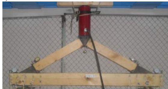
Рисунок 4. Экспериментальная модель опорного узла треугольной фермы:
